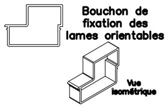
**Bouchon de fixation des lames orientables**
